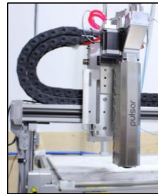
Pulsar Pellet Extruder (Dyze Design)
